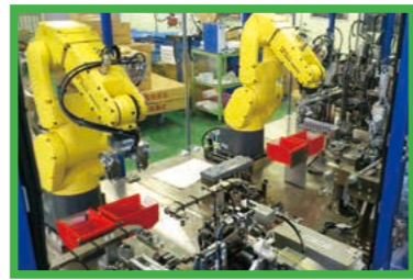
1台で複数品目を生産 ⇒多間接ロボットの活用 ⇒段取り換えの時間短縮
