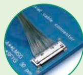
極細線同軸ケーブル用コネクタ
